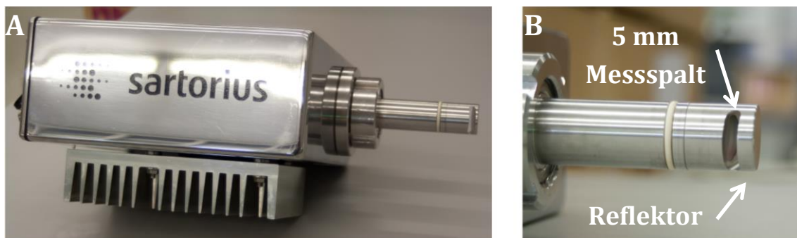
Abb. 3.3: Verwendetes NIR-Spektrometer mit Freistrahloptik (A) und Großaufnahme der Sonde mit 5 mm Messspalt – Schichtdicke 10 mm (B).
