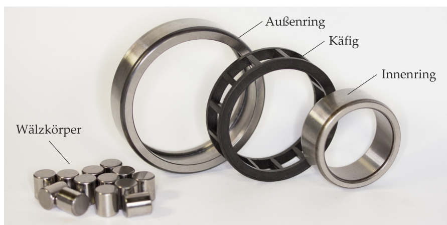
Abbildung 2.1: Komponenten eines Wälzlagers
