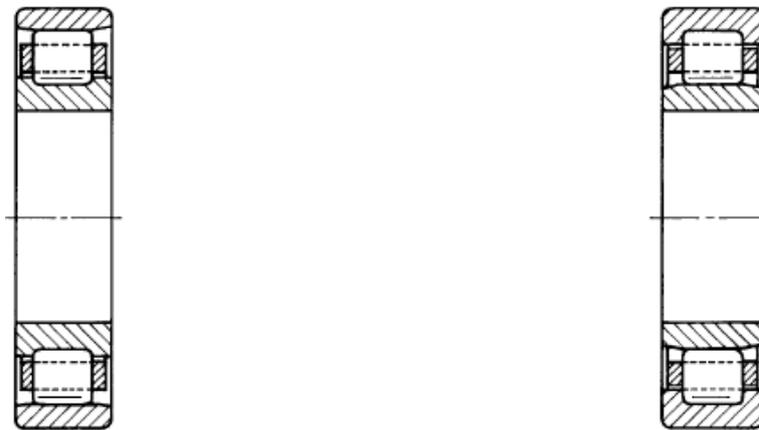
Abbildung 3: Zylinderrollenlager der Bauform N (li.) und NU (re.) [7]
