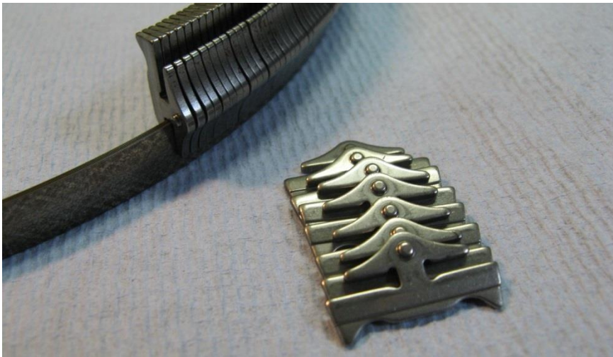
Abbildung 3.14: geöffnertes Schubgliederband (Hintergrund) und Elemente eines Schubgliederbandes (Vordergrund)
