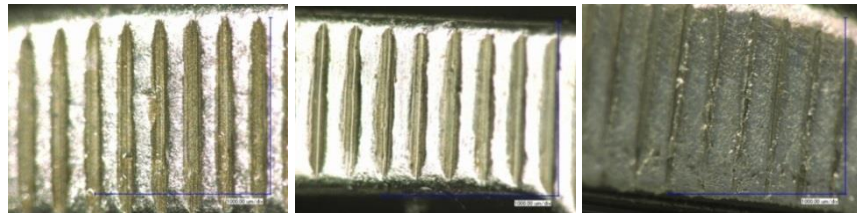
Abbildung 5.18: Schubgliederbandflanke links: ungelaufen; Mitte: nach Dauerlauf mit geschliffenen Variatorscheiben; rechts: nach dem Dauerlauf mit kugelgestrahlten Variatorscheiben (Ausschnitt ca. 1 mm x 1,5 mm)
