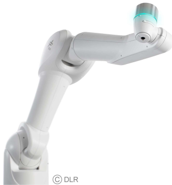
(a) DLR MIRO, 7-achsiger Medizinroboter mit Momentensensorik [50], Bild: DLR
