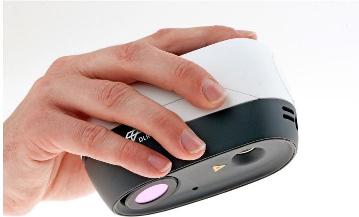
Abbildung 5.21: Der VR-SCAN als handgeführter Sensor
