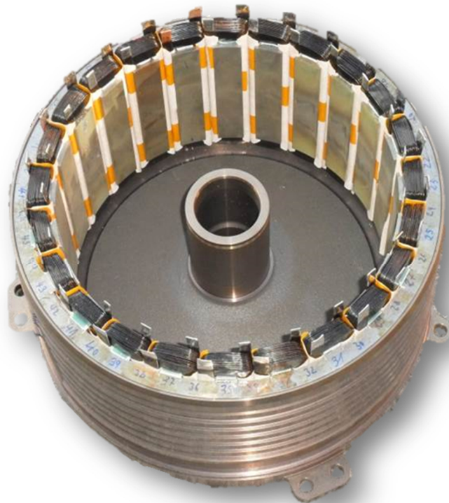
Abbildung 3-3: Stator im Kühlmantel
