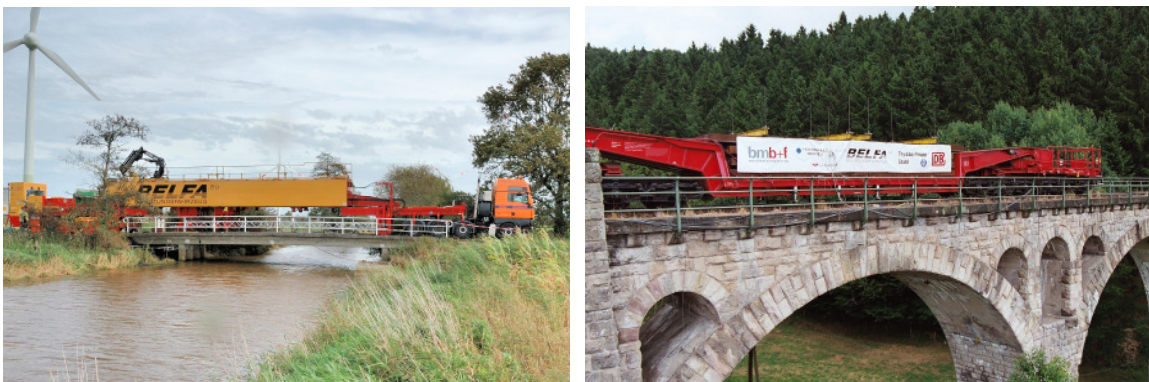
Abbildung 26: Belastungsfahrzeuge BELFA für Straßenbrücken (links) und BELFA-DB für Eisenbahnbrücken (rechts)
