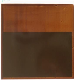
Abb. 6.4: Lackschicht ( \text{Fe}_2\text{O}_3 - und \text{CuO} -haltig, inkl. Oberflächenadditiv BYK-UV 3570) mit niedrigerer Viskosität nach der Applikation mittels 30 \mu\text{m} -Spiralraketel und ca. 40 min Wartezeit vor der UV-Aushärtung.
