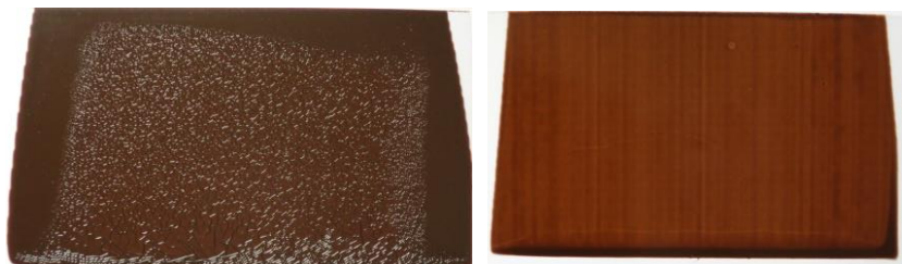
Abb. 6.2: Lackschichten ( \text{Fe}_2\text{O}_3 - und \text{CuO} -haltig) auf Polyesterfolien nach der Applikation mittels Spiralrakel und UV-Aushärtung: Orangenhaut-Effekt nach Applikation mittels 75 µm-Rakel (links); leichte Rakelstreifen, aber keine Löcher nach Applikation mittels 30 µm-Rakel und ca. 40 min Wartezeit vor der UV-Aushärtung (rechts).
