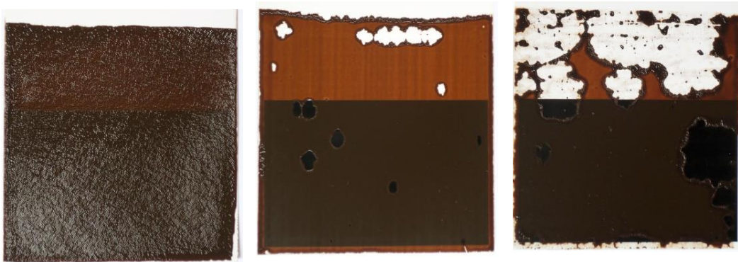
Abb. 6.1: Lackschichten (Fe 2 O 3 - und CuO-haltig) auf Lackprüfkarten nach der Applikation mittels Spiralraketel und UV-Aushärtung: Orangenhaut-Effekt nach Applikation mittels 75 µm-Raketel (links); Raketelstreifen nach Applikation mittels 30 µm-Raketel (Mitte); Löcher nach Applikation mittels 30 µm-Raketel und ca. 40 min Wartezeit vor der UV-Aushärtung (rechts).
