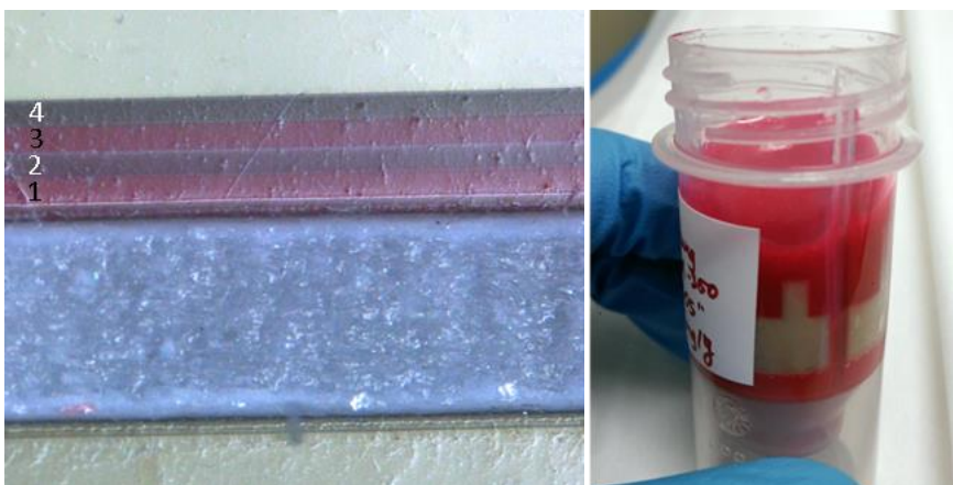
Abb. 8.3: Digitale Lichtmikroskopaufnahme des Querschnittes eines in Epoxidharz eingebetteten Multischichtsystems, bei dem zwei der vier Schichten (Schicht Nr. 1 + 3) den roten Farbstoff Lumogen F305 enthalten (links). Foto einer flüssigen Lackmischung, die den roten Farbstoff Lumogen F305 enthält (rechts).
