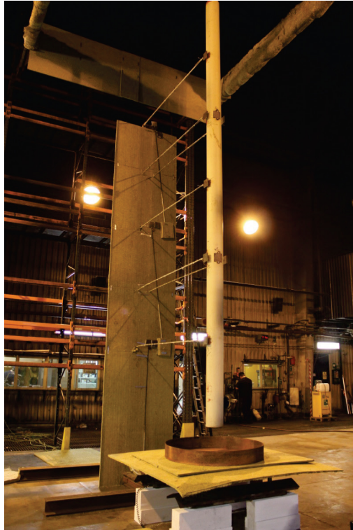
Abbildung 19: Versuchsaufbau einer Stütze mit flüssiger Brandlast aus [Sjöström2013]
