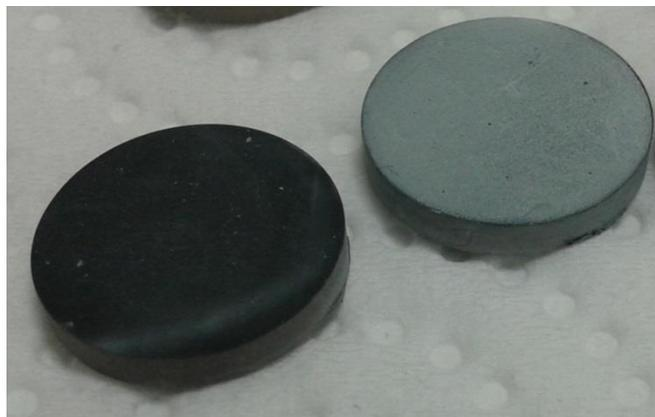
**Abbildung 45:** strukturierte Titanplatte vor der Silanisierung **91** (links) und nach der Silanisierung **96** (rechts).
