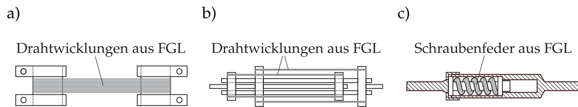
Abbildung 2.15: Dämpfungselemente zur Schwingungsminderung in Bauwerken:
