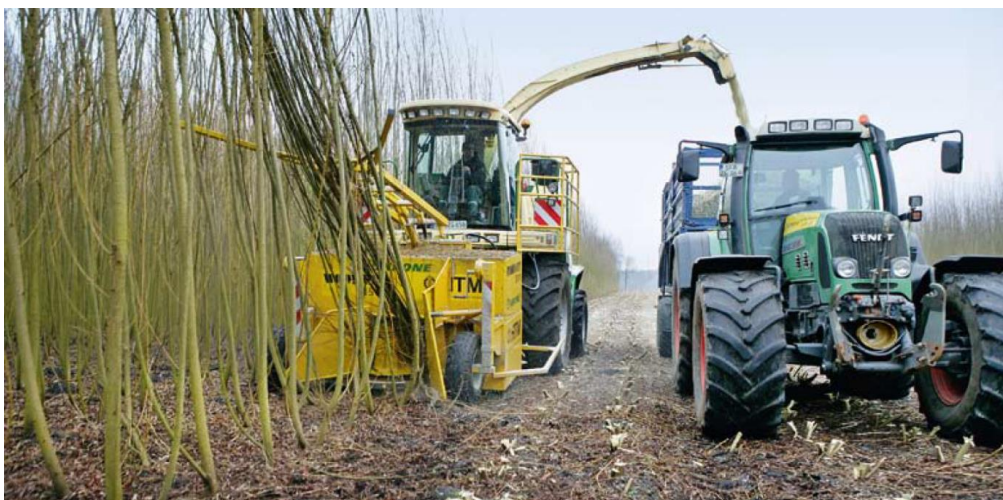
Abbildung 58: KUP-Ernte mit dem ‚WoodCut 1500‘ , den KUP-Pionier Joachim Hüttmann gemeinsam mit der Firma Krone entwickelt hat (Foto: FNR)
