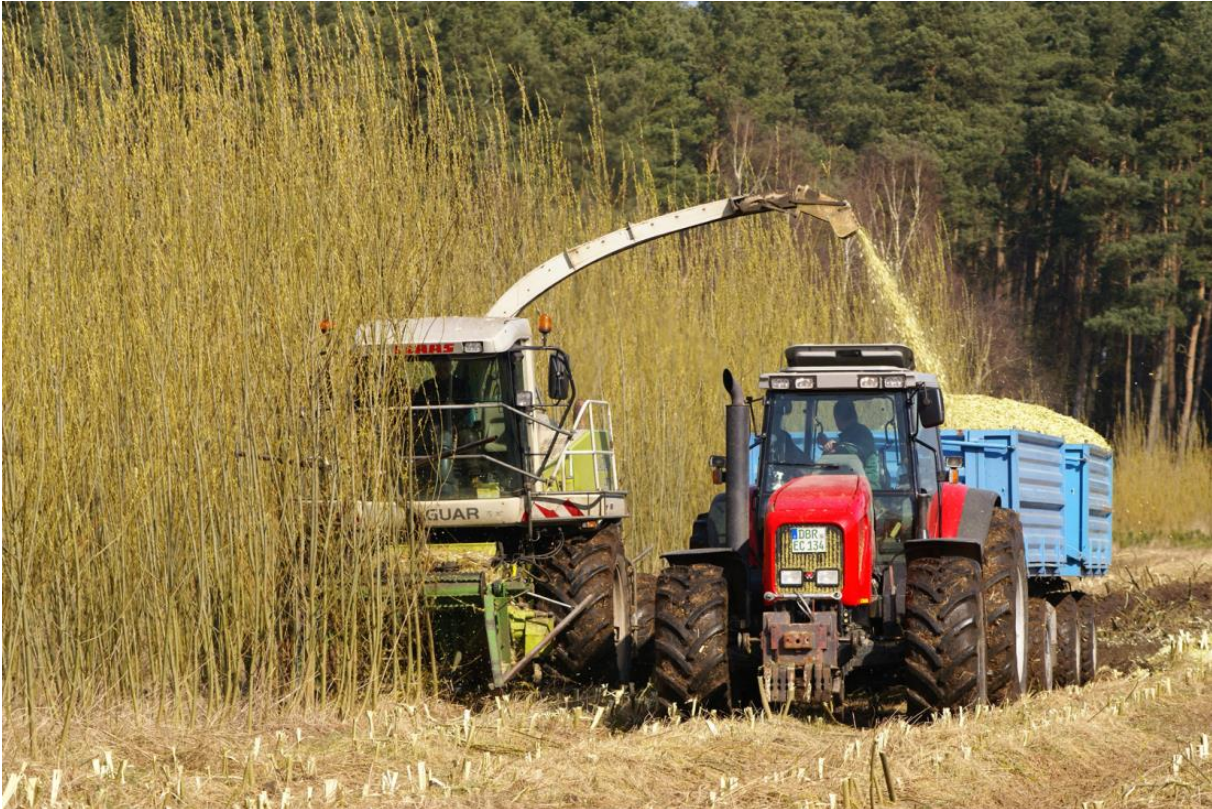
Abbildung 36: Ernte einer Kurzumtriebsplantage aus Pappeln . Der Häcksler zerkleinert die Gehölze zu Holzhackschnitteln, die energetisch oder stofflich verwertet werden können (Foto: FNR / M. Weitz)
