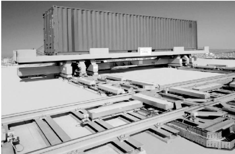
Abbildung 4.6.: Die im MegaHub-Lehrte angedachte Längsförderanlage besteht aus schienengebundenen AGVs, die mittels eines Linearmotors angetrieben werden. (Quelle: Rotter (2004))
