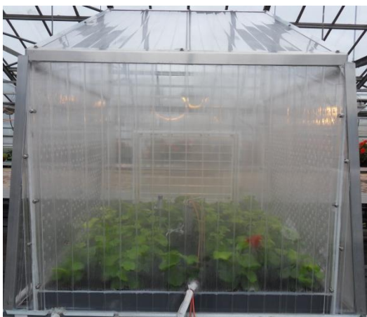
Abb. 6.2: Kondensat an der Innenseite der TPK infolge einer Taupunktunterschreitung
