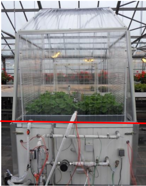
Abb. 4.2: Frontalansicht TPK. Die rote Linie trennt symbolisch die Bereiche Pflanzeneinheit (oben) und Luftkonditionierungseinheit (unten).
