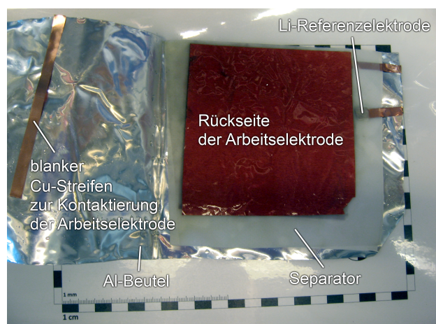
Abbildung A.2: Die geöffnete Pouch-Zelle nach erfolgter Lithiierung mit Blick auf die Rückseite der Arbeitselektrode.
