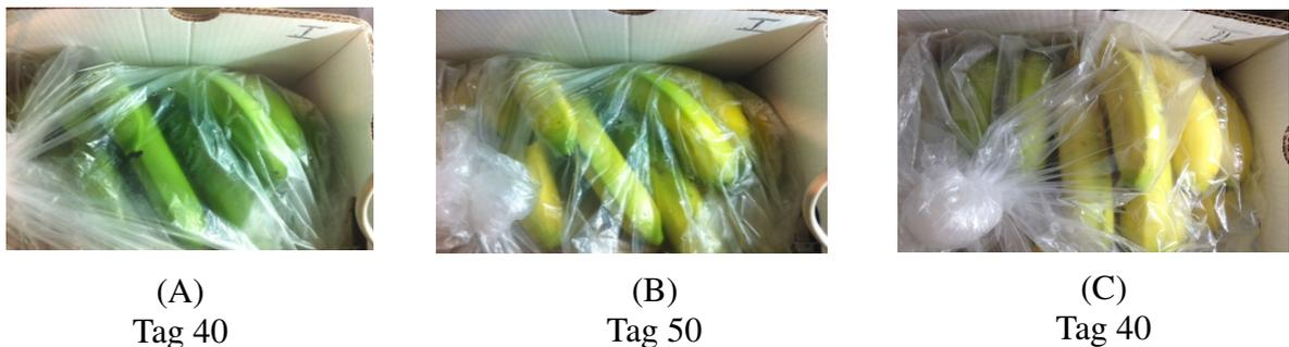
**Abbildung 18:** Darstellung des Reifefortschritts der Versuchsbananen in C1 (A und B) und C2 (C) während des ersten AB-Vergleichs. Die Lagerung erfolgte 40 Tage im C2 ohne Ionisation und 50 Tage im C1 mit Ionisation (3 Typ B, 40 mesh, IS 1) mit einer Fracht von 18 kg *Turbana* Bananen, Reifegrad 2, bei 13,5 °C mit aktiver Luftzufuhr.
