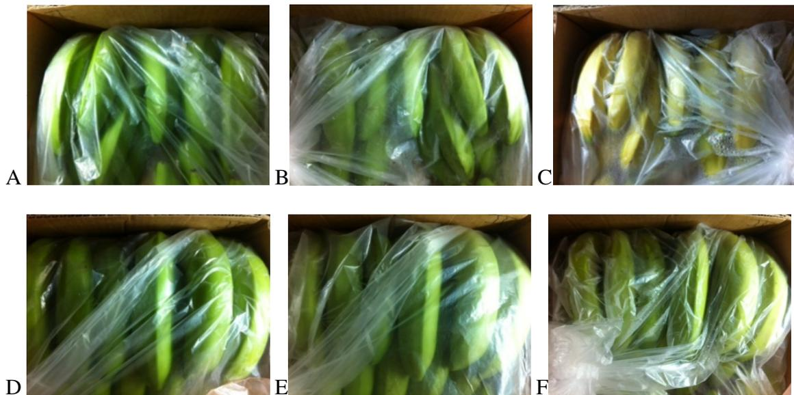
Abbildung 36: Darstellung des Reifefortschritts der Versuchsbananen an Tag 0, 11 und 14 in C1 (A-C) und C2 (D-E) während des siebten AB-Vergleichs. Die Lagerung erfolgte 14 Tage mit einer Fracht von 18 kg *Turbana* Bananen, Reifegrad 2-3, bei 22 °C ohne aktive Druckluftzufuhr, aber mit öffnen und schließen der Entnahme Klappe. Ventilation war angeschaltet. Ionisation (3 Typ B, 40 mesh, IS 1-3) wurde in C1 angewandt.
