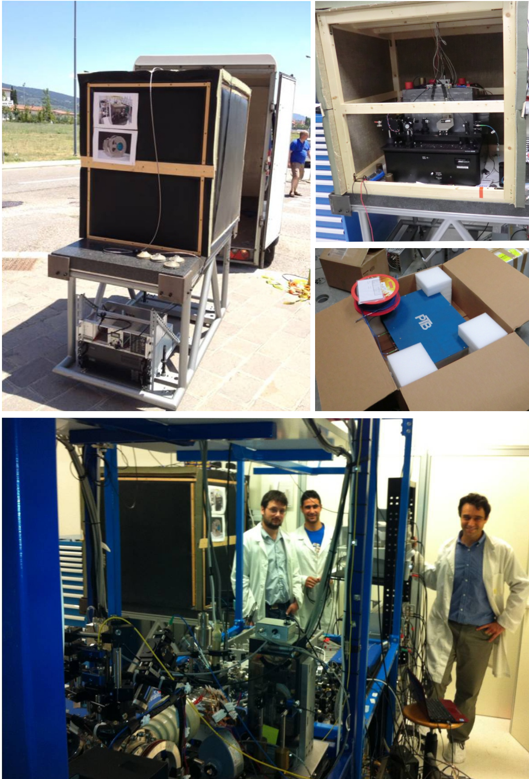
Abbildung 3.17: Bilder vom Transport des Uhrenlasersystems. Oben links ist der Resonatoraufbau vor dem Gebäude der UNIFI zu sehen, rechts sieht man Detailansichten zum Uhrenlaser und Resonator. Das untere Bild wurde während der erfolgreichen Integration in den SOC Apparat aufgenommen. Die Personen im Bild sind von links nach rechts: Stefan Vogt, Marco Schioppo und Nicola Poli.
