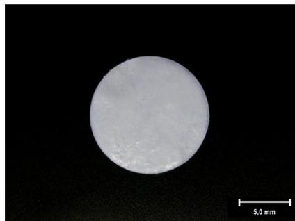
**Abbildung 5.14:** Lichtmikroskopische Aufnahme einer als Arbeitsreferenzmaterial verwendeten Tablette aus PLA/PMMA-Blend. Kantenlänge Abbildung und Vergrößerung:  $29 \times 21 \text{ mm}$ , 10x.
