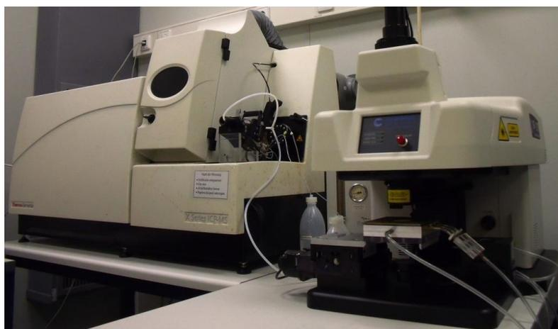
**Abbildung 4.3:** ns-LA-ICP-QMS-System.
