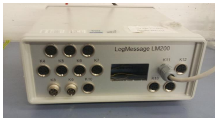
Abb. 18: Foto des verwendeten Mess- und Regelungssystems (MRS). Die Anschlüsse K1 bis K14 können für verschiedene Sensoren verwendet werden.
