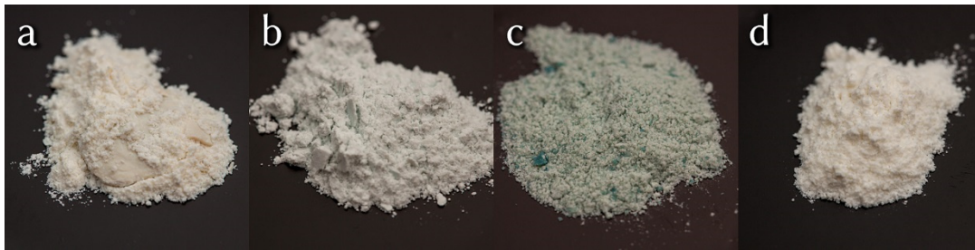
Abbildung 22: Fotografien von Zinkoxidproben, die ohne Zusatz (a) und mit jeweils 5% Gallium(III)-nitrat (b), Indium(III)-nitrat (c) und Titan(IV)-tetraisopropoxid (d) hergestellt wurden.
