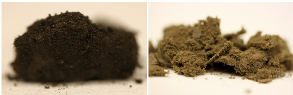
Abbildung 74: Fotografische Aufnahmen von Graphitoxid (links) und hochoxidiertem Graphitoxid (rechts), letzteres unter Zugabe von Phosphorsäure hergestellt. Erkennbar ist ein deutlicher Helligkeitsunterschied der Materialien.
