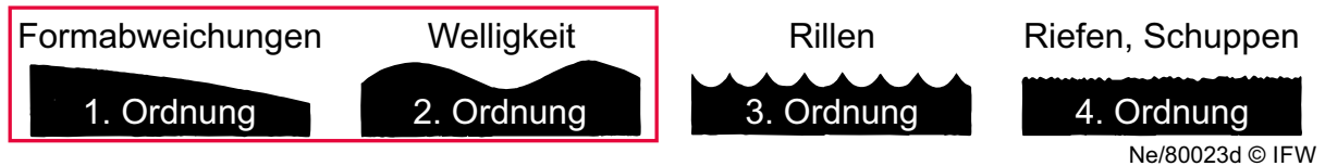
Bild 9.7: Gestaltabweichungen nach DIN 4760. Fokus: 1-2. Ordnung, Werkzeugabdrängung
