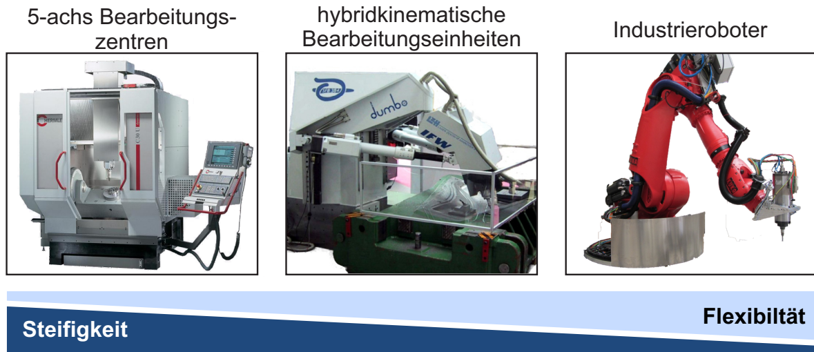
Bild 2.3: Verwendete Maschinen für die Rekonturierung [Bre06a, Möh08, Leh12]
