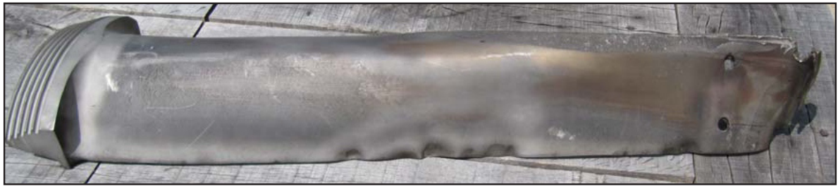
Bild 2.6: Schaden an einer 12CrNiMo Schaufel einer 600 MW Turbinengenerators durch Verlust einer Schaufel während des Betriebs [Jam10]
