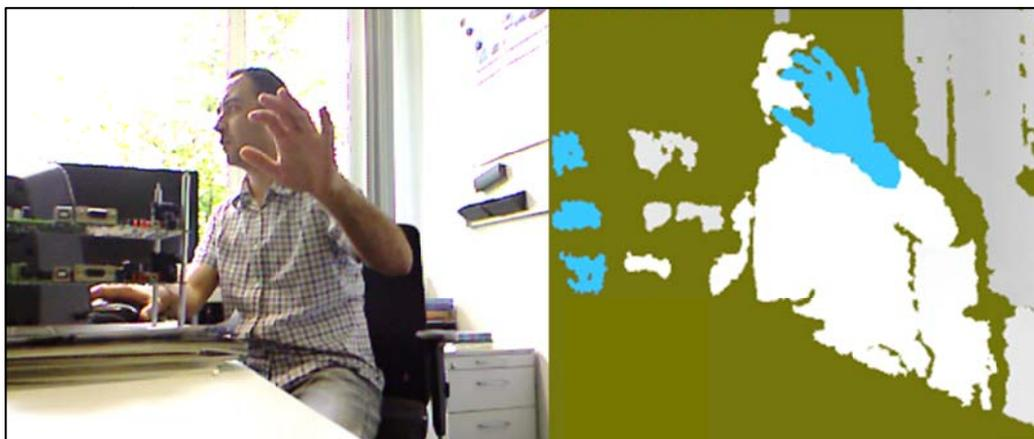
Abbildung 8: Vergleich von Kamerabild und Tiefenbild
