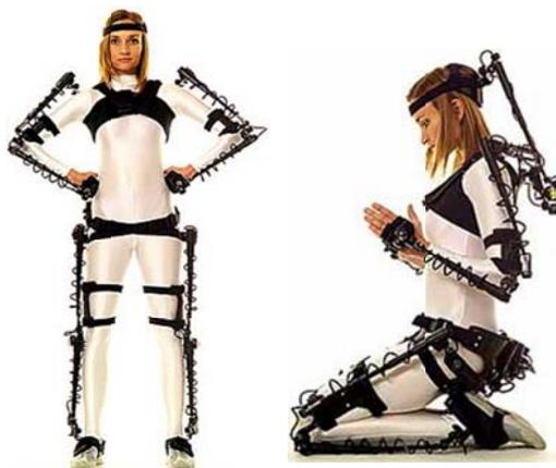
Abbildung 5: Motion Capturing mit einem Exoskelett [Jac06]
