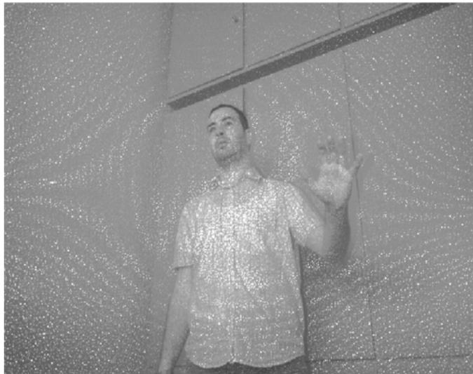
Abbildung 7: Punktmuster der Kinect Kamera
