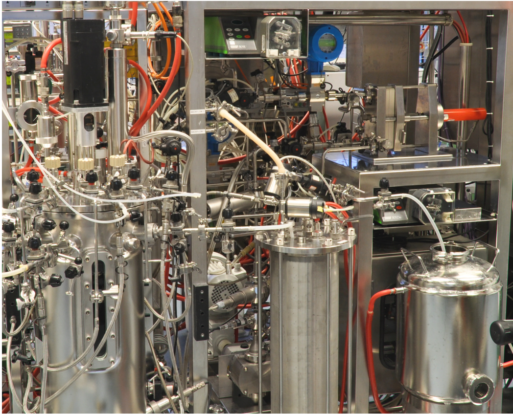
Abb. 4.6: Produktionsreaktor BIOSTAT ® C30 (links) und Mikrofiltrationsanlage Sartocon ® Slice (rechts) mit Retentat- und Permeattank
