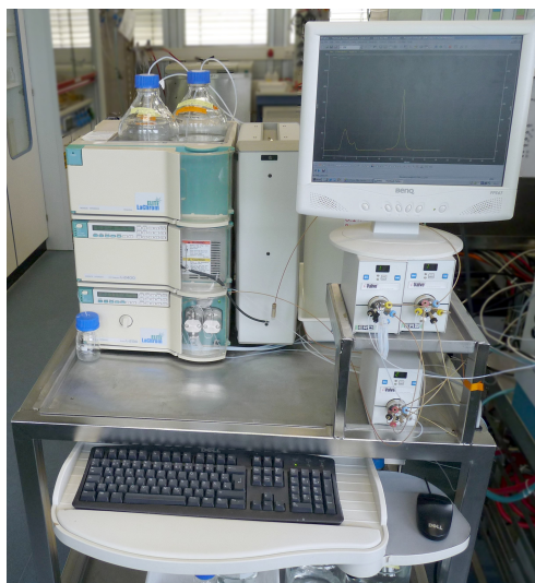
Abb. 4.14: HPLC LaChrom Elite zur Bestimmung der Produktkonzentration
