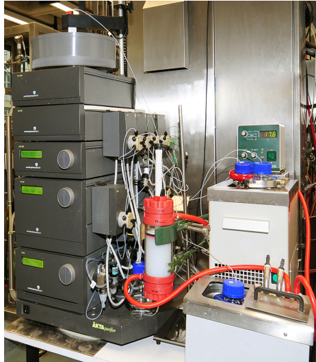
Abb. 4.9: Chromatographiesystem ÄKTApurifier 100 mit präparativer Säule
