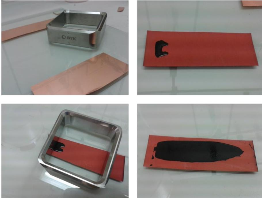
Abb. 55: Schritte beim Aufbringen der Aktivmaterial suspension mit einer Raket.
