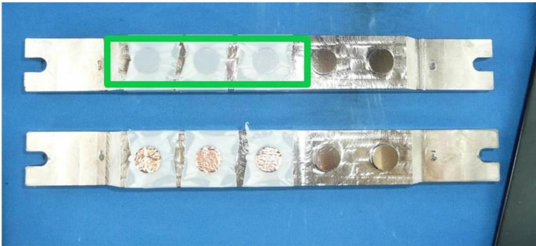
Abb. 73: Ergebnis der Haftfestigkeitsmessung von kupferdekoriertem MCMB (7,6 wt%) auf einem Kupferstromsammler. Der Abriss fand in allen Versuchen am Klebeband (grün) statt.
