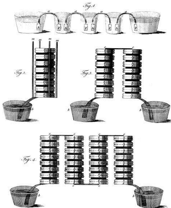
Abb. 2: Schematische Darstellung verschiedener Formen der Voltaschen Säule. Figur 1 zeigt einen sogenannten Tassenapparat, die Figuren 2-4 zeigen Voltasche Säulen verschiedener Stärke [5].
