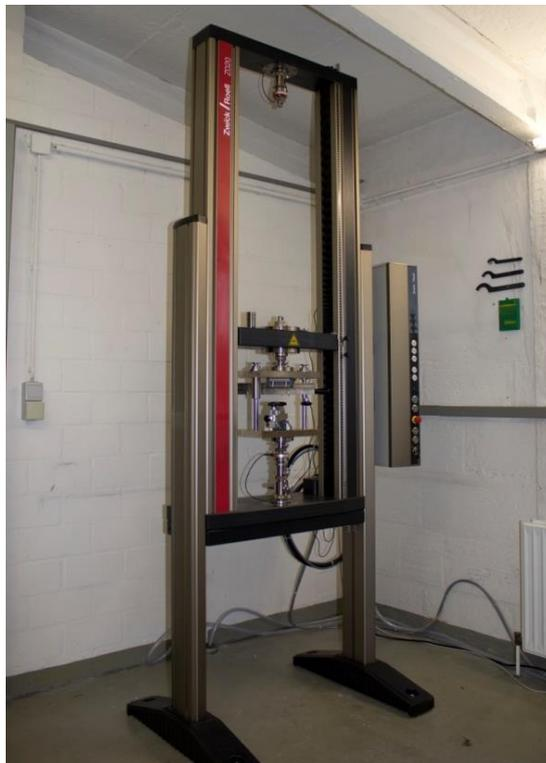
Abb. 71: Messstand zur Haftfestigkeitsbestimmung am Institut für Partikeltechnik der Technischen Universität Braunschweig.
