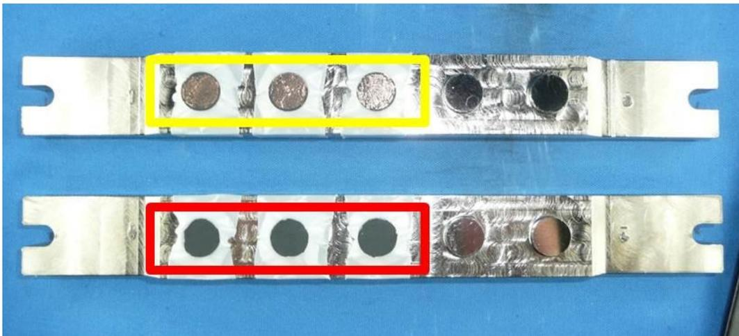
Abb. 72: Halterung für die Haftfestigkeitsmessungen. Der Abriss zwischen nicht modifizierten MCMB und dem Kupferstromsammler fand immer an der Grenzfläche zwischen Aktivmaterial (rot) und Stromsammler (gelb) statt.
