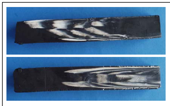
Bild 110: Plastilin ohne Schmiermittel verpresst, Pressrichtung nach links
