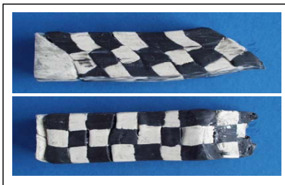
Bild 109: Plastilin mit Schmiermittel verpresst, Pressrichtung nach links
