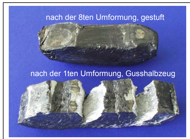
Bild 114: Mittels ECAE-Verfahren bei 180^\circ\text{C} umgeformte Proben; oben: korngesteuerte Probe nach der 8ten Umformung; unten: Probe aus dem Gusszustand umgeformt
