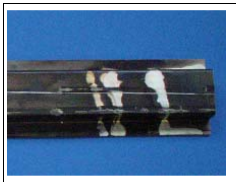
Bild 62: Oberflächenverfärbung an einer stranggepressten AM50
