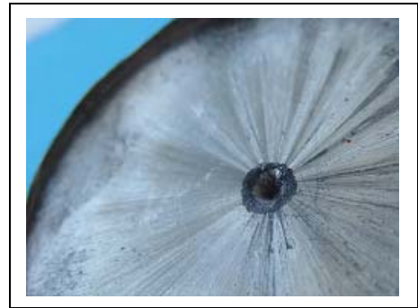
Bild 70: Presslunker an einem Pressrest einer AM50-Legierung, stempelseitig
