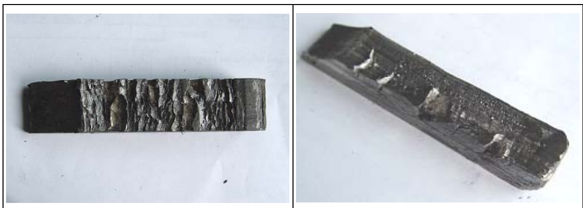
Bild 99: Rissbildung auf der Probenoberfläche nach Verfahrensroutenroute A (links) und B_A (rechts)
