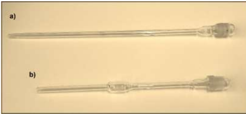
Abbildung 4.1.1: verwendeten Knudsenzellen. a) einfache Zelle, b) Doppelzelle
