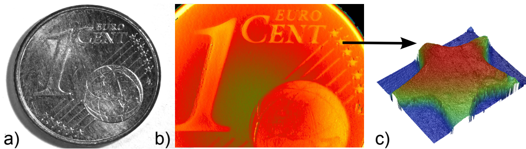
Abbildung 4.2: Aufnahme eines 1 Cent Stückes mit a) telezentrischer Kamera b) Mikrostreifenprojektionssystem c) Weißlichinterferometer
