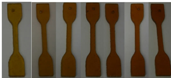
Abbildung 4-98: Optische Veränderung der EPDM 1-Vulkanisate mit 5 phr DCP und 0,5 phr TMQ bei einer Alterungstemperatur von 120°C in Abhängigkeit der Alterungszeit (von links nach rechts: 3, 7, 14, 21, 28, 35 und 42 Tage)
