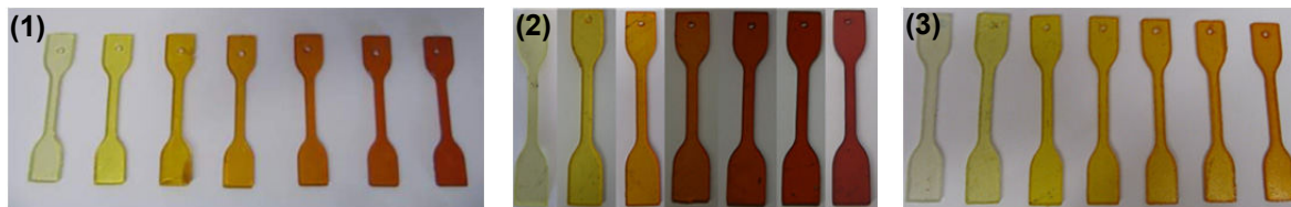
Abbildung 4-90: Veränderung der Materialien mit 2,5 phr DCP und 2,5 phr TAIC: (1) EPDM 1, (2) EPDM 2, (3) EPDM 3 bei einer Alterungstemperatur von 120°C in Abhängigkeit der Alterungszeit (je Bild von links nach rechts: 3, 7, 14, 21, 28, 35 und 42 Tage)
