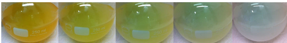
Abbildung 4-32: Farbänderung von gelb zu farblos während der Titration mit einer Natriumthiosulfatlösung (5 phr DCP in EPDM 1 - unvernetzt)
