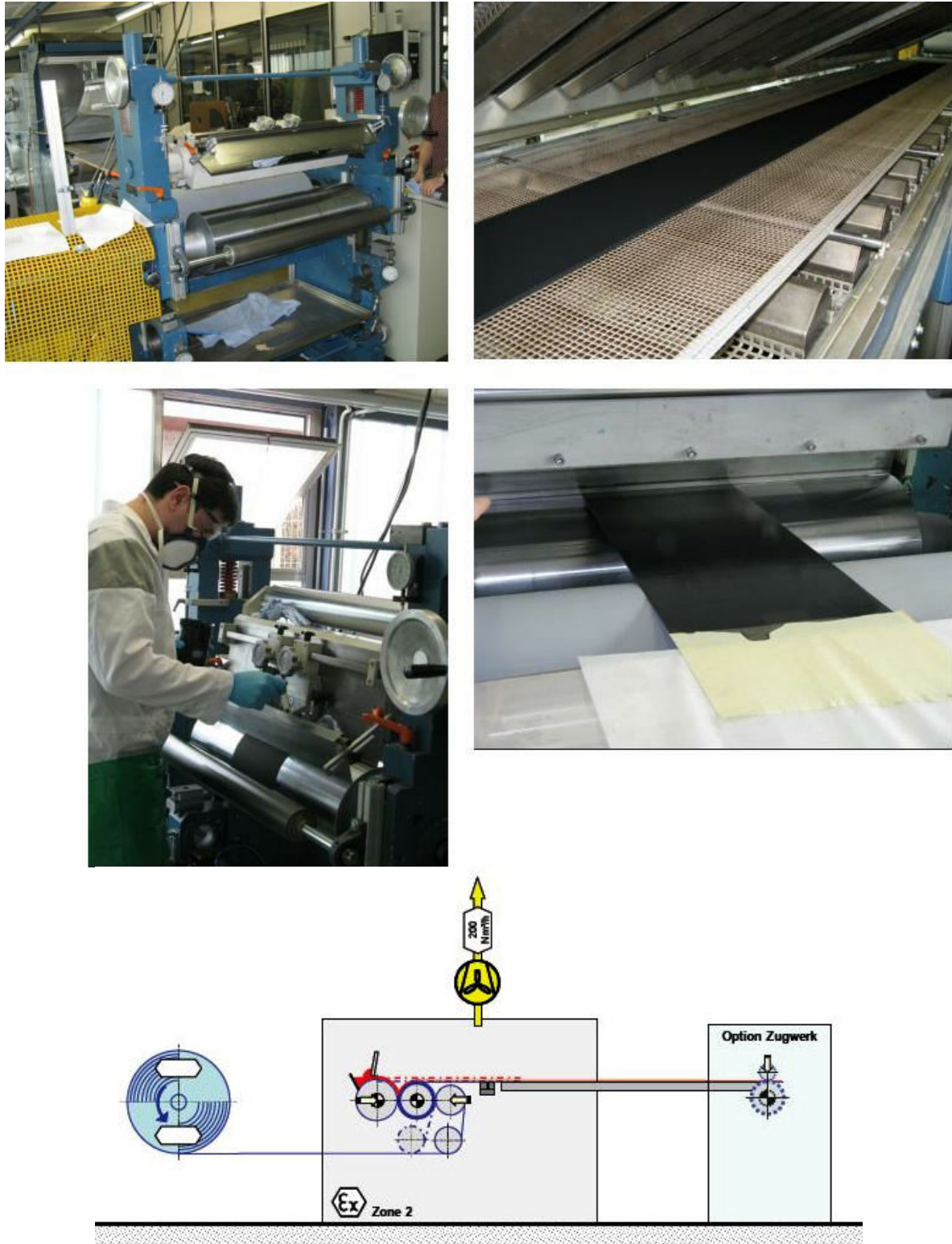
Abbildung 41: Fertigung von Elektroden an einer kontinuierlichen Laborbeschichtungsanlage. Das Bild links oben zeigt Antriebswalzen, Umlenkrollen und das Messerrakel, rechts oben: Umlufttrockner mit einer Elektroden-Bahn, links und rechts mittig: Beschichtungswerk während des Betriebs, unten: beschichtete GDL. Schematische Darstellung der Laborbeschichtungsanlage (untere Abbildung).
