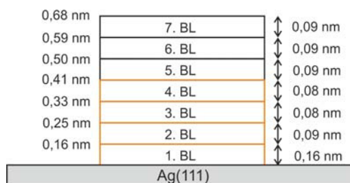
Abbildung 4.16: Schematische Darstellung der scheinbaren Höhen der aus den Höhenhistogrammen ermittelten Lagen für D 2 O auf Ag(111). Die orangefarbenen Lagen markieren die gefundenen Lagen bei amorphen Wasserclustern und -Inseln. Rechts: scheinbare Höhendifferenz zwischen den einzelnen Lagen.
