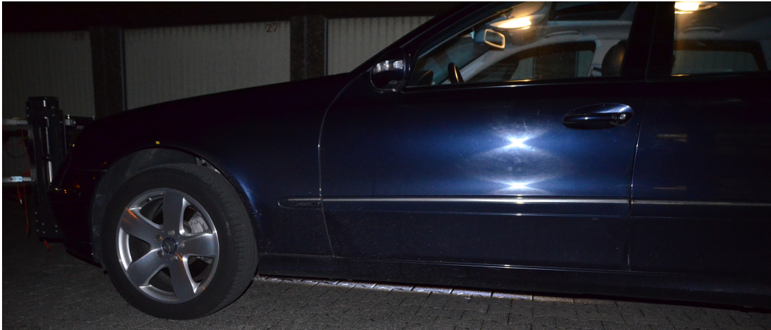
Abbildung 5.4: Vom Lichtmodul unterhalb des Versuchsfahrzeuges erzeugtes Messlicht
