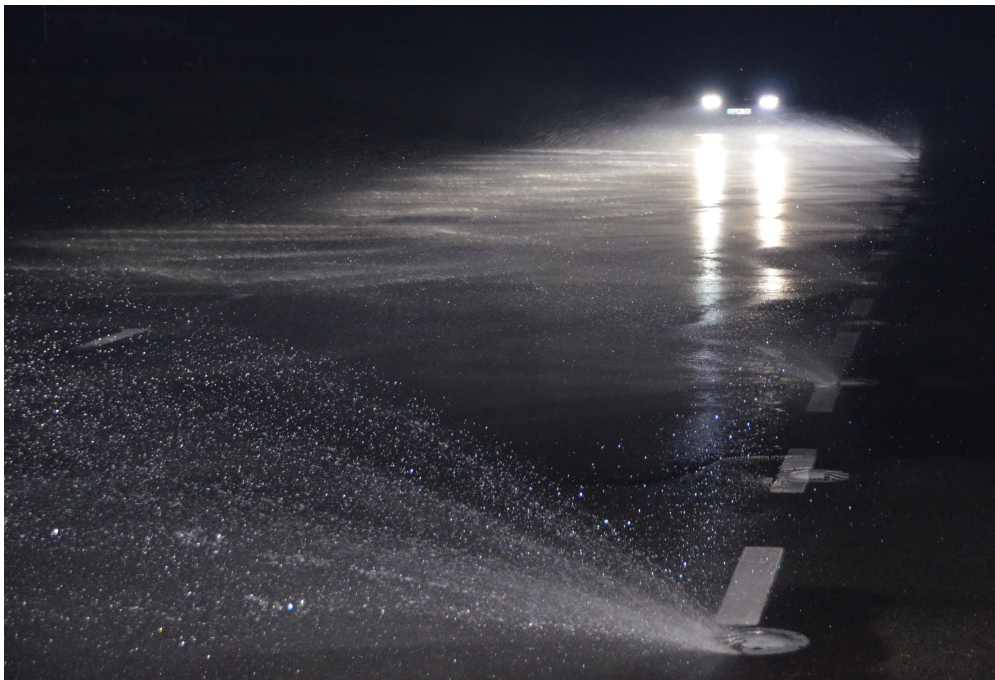
Abbildung 3.2: Bewässerung einer Fahrbahn auf der Fahrtrainingsanlage des ADAC Ostwestfalen-Lippe e.V.
