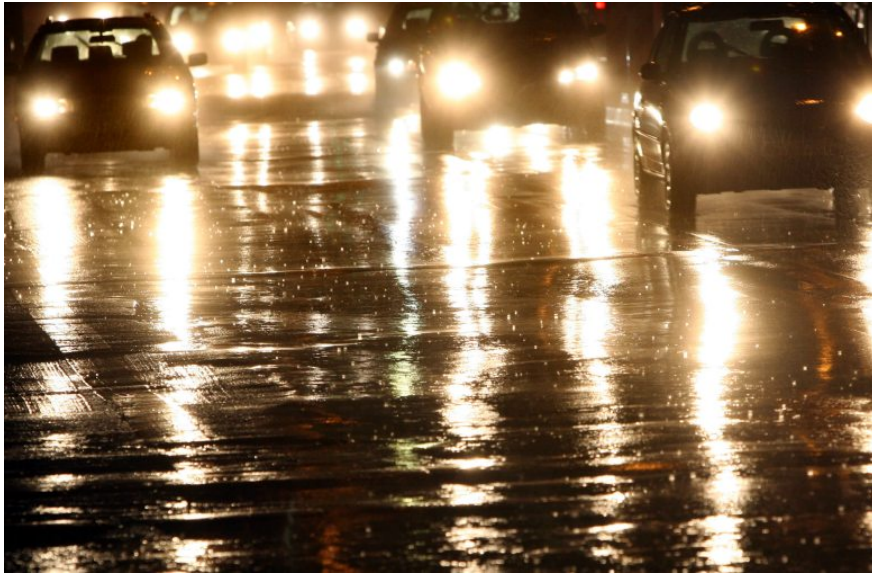
Abbildung 1.1: Bei einer nassen Fahrbahn auftretende Blendkeulen durch die Scheinwerfer entgegenkommender Fahrzeuge [NTV13]
