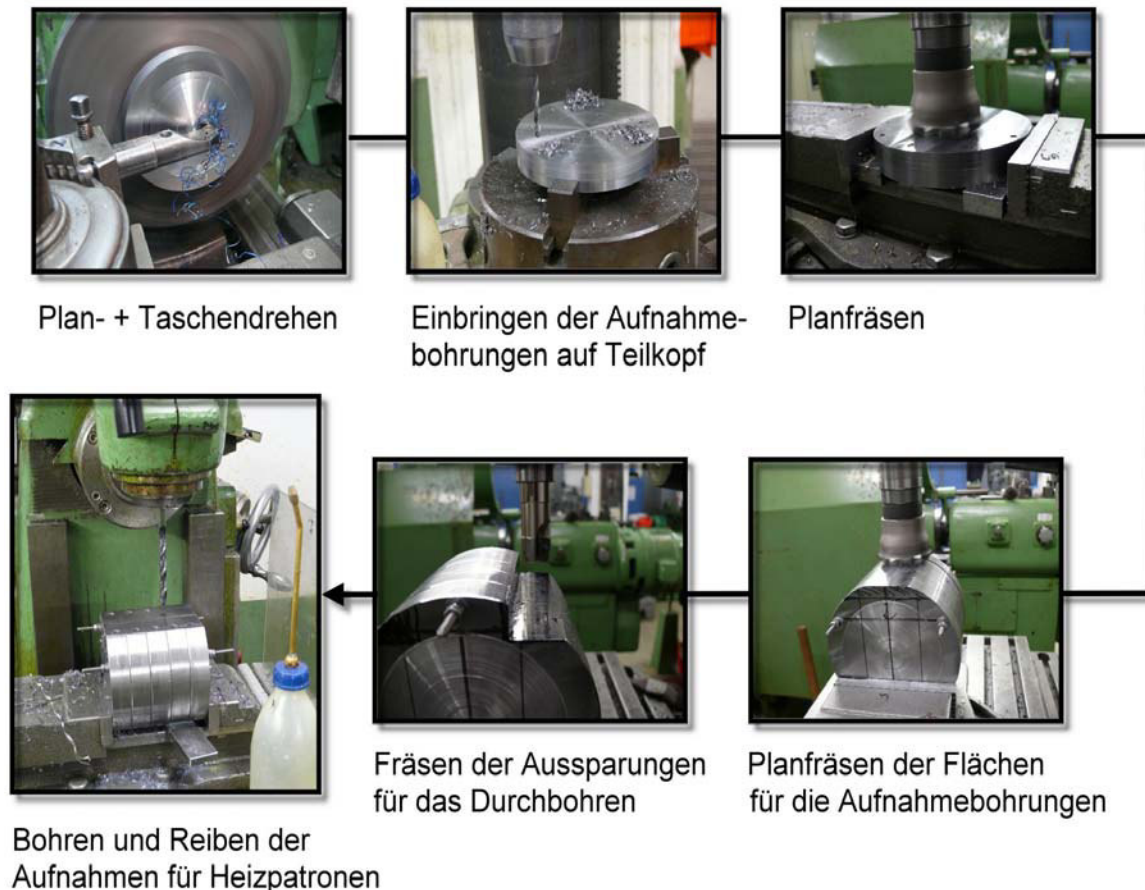
Bild 6.10: Fertigungsschritte der Stauchplatten
