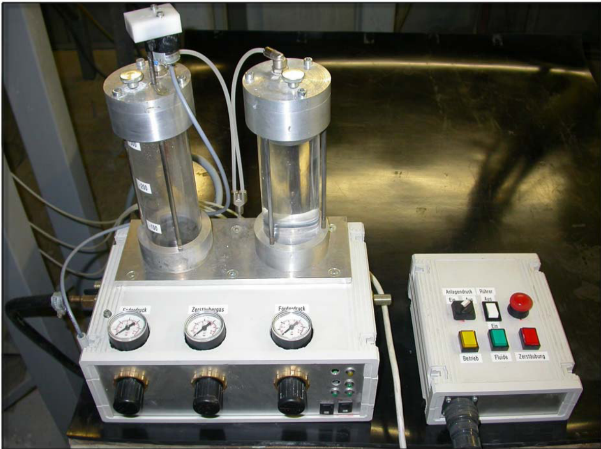
Bild 5.3.: Ausgangskonfiguration des Suspensionsförderers mit Fördereinheit (links) und Steuereinheit (rechts)
