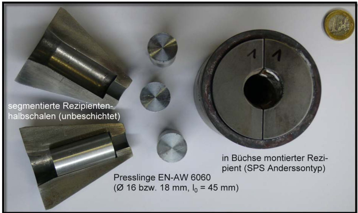
Bild 6.18: Geöffnete Rezipientenhalbschalen, Presslinge und in der Büchse montierter Rezipient für den Stauchversuch
