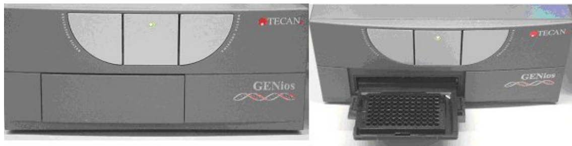
Bild 6.13: GENios™ Fluoreszenzreader, rechts mit schwarzer 96-Well Mikrotiterplatte
