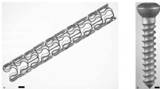
Abb. 2.3 und 2.4: Stent und Schraube aus Magnesiumlegierungen. Der Maßstabsbalken entspricht einem Millimeter. [5]
