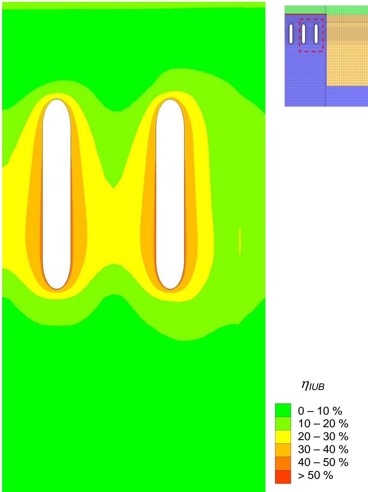
Bild 6.46 Berechnungsergebnisse für p_{i-min} = 45 bar / Ausnutzungsgrad \eta_{IUB} zum Zeitpunkt nach Erreichen des Minimaldruckes im Vertikalschnitt / verminderte Festigkeit ÜZ Modell G
