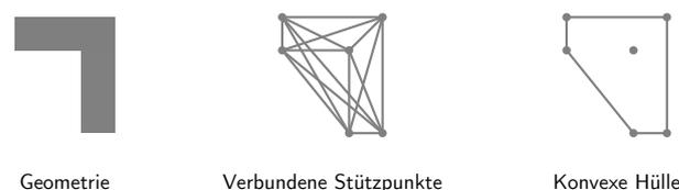
Abbildung 2.4: Konstruktion der komplexen Hülle einer Objektgeometrie
