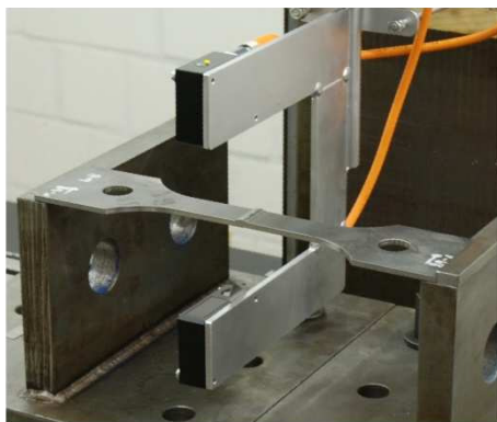
Abb. 3-7: Aufbau der Lasermessung (links) und Beispiel eines Messschriebs (rechts)
