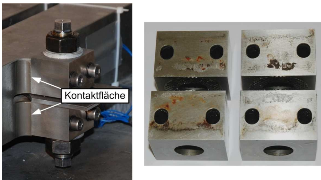
Abb. 4-14: Abnutzungserscheinungen auf den Kontaktflächen der Spannklotze zum Prüfrahen nach Langzeitversuch
