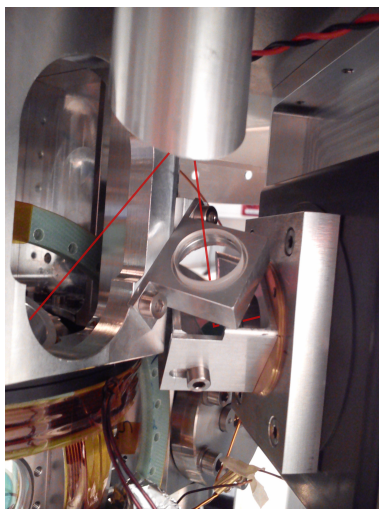
Abbildung 3.16: Aufnahme der gefalteten Strahlenganges der Absorptionsdetektion: Das Licht kommt von links aus der Vakuumkammer und durchläuft kurz danach eine in der Aufnahme verdeckte Linse. Verändert übernommen aus [Mön14].
