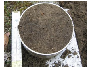
Abbildung 23: Stechzylinder zur Bestimmung der Lagerungsdichte
