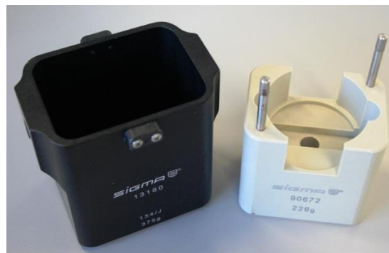
Abb. 20: Zentrifugenbecher und –Adapter für die Zentrifugation der Membrantransfer- und –Auflöseinheit (Sigma)
