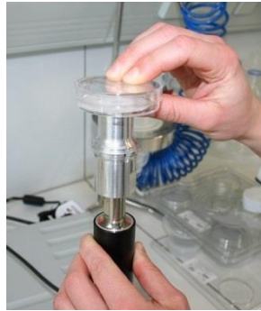
Abb. 13: Versuchsaufbau: Ultraschallsonde, Petrischale mit 6 M Guanidinhydrochlorid und 0,45 \mu\text{m} Polyethersulfon-Membran mit zurückgehaltenen E. coli Zellen
