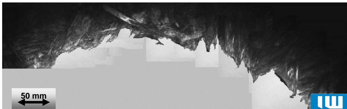
Abbildung 285: Transmissionselektronenmikroskopische Übersichtsaufnahme (zusammengesetzte Einzelbilder) des gehärteten Demonstratorbauteils aus 22MnB5 (Probenstelle 2) [SPR09]
