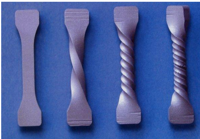
Abbildung 30: Verdrehte Proben aus TWIP-Stahl (Quelle: MPIE)
