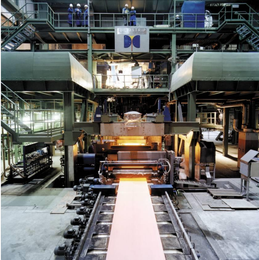
Abbildung 135: Bandgussanlage nach dem Strip-Casting-Prinzip bei ThyssenKrupp in Krefeld (Quelle: ThyssenKrupp)
