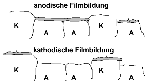
Abbildung 162: Modell der kathodischen und anodischen Niederschlagsätzung nach [AGN06]
