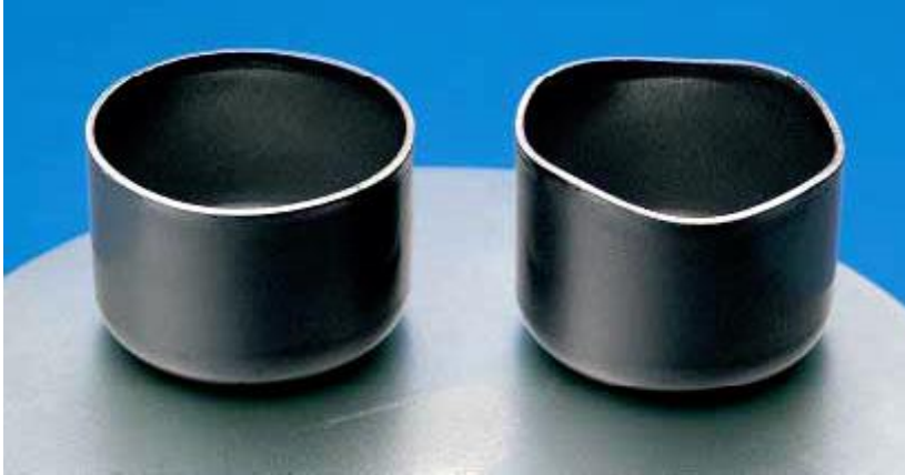
Abbildung 20: Blech mit und ohne Zipfel nach dem Tiefziehen (Quelle: Salzgitter AG)
