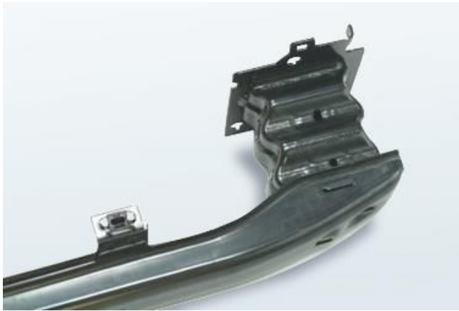
Abbildung 14: Vorderer Stoßfängerträger (DP780) und Stoßdämpfer aus HSLA 300 (Quelle: Arcelor)
