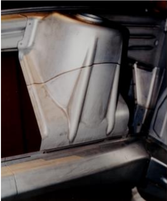
Abbildung 143: Rechter vorderer Federdom aus Tailored Blank (Quelle ULSAB)
