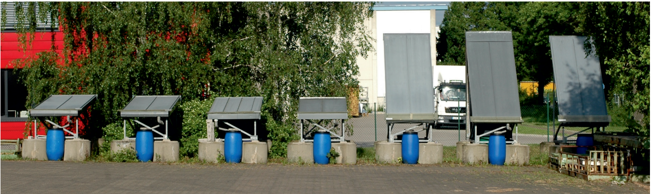
Abbildung 113: Dachflächen-Freibewitterungsversuch in Hannover-Langenhagen, Standort B. Dritter Versuchsabschnitt: 20.10.2003 bis 19.10.2013. Gesamtansicht.
