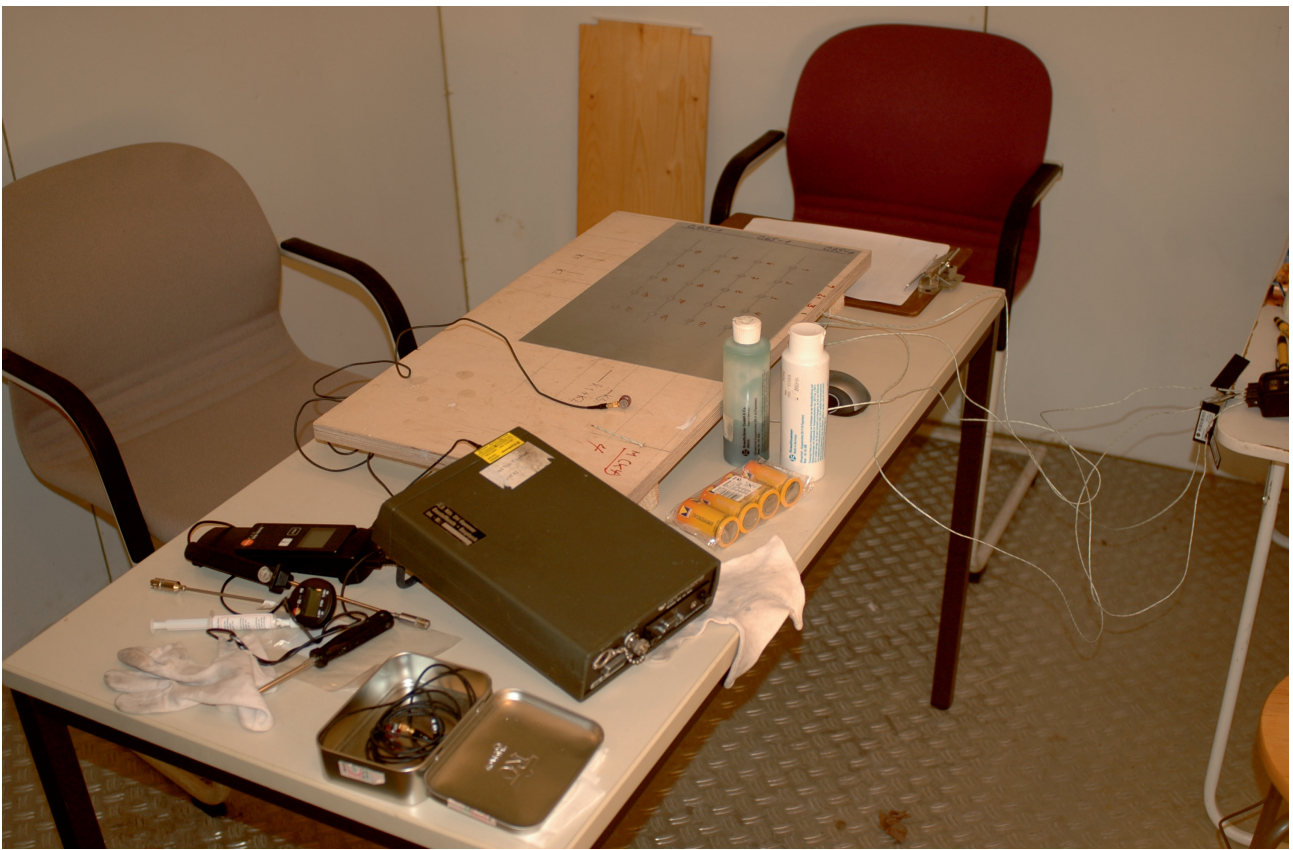
Abbildung 39: Arbeitstisch mit Probetafel, Messgeräten und Prüfbühnen in der Klimakammer.
