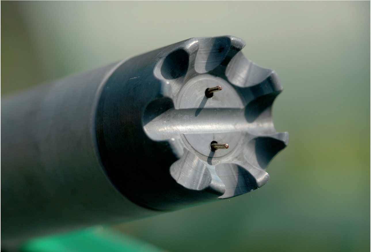
Abbildung 67: Peilstab mit Batterie. Elektrische Kontakte erzeugen ein akustisches Signal bei Berührung der Wasseroberfläche.
