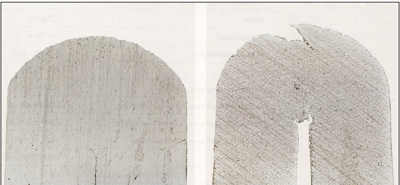
Abbildung 25: Faltversuch, Querschliff an Biegeproben nach einer Faltung um 180° ohne Zwischenlage parallel zur Walzrichtung. Unlegiertes Zink (rechts) bricht, während Titanzink (links) anrissfrei bleibt. © Rhein-zink.
