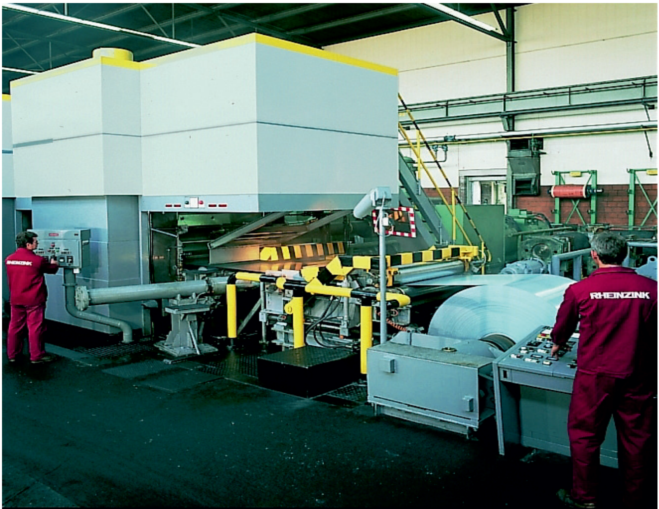
Abbildung 12: Aufwickeln des fertig gewalzten Materials zu 20 to schweren Großcoils am Ende der Walzstraße. © Rheinzink.
