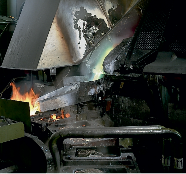
Abbildung 8: Abguss der Vorlegierung aus dem Induktionstiegelofen in eine Gussform. © Rheinzink.
