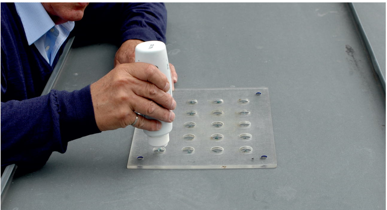
Abbildung 27: Aufbringen des Koppelmittels im Bereich der 20 Bohrungen.
