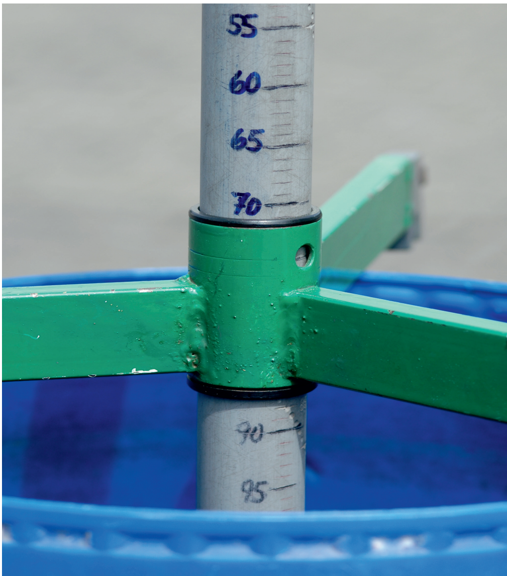
Abbildung 66: Tonne mit Peilstab - Liter-Markierungen. Messung der Niederschlagsmenge vor der Probenentnahme.
