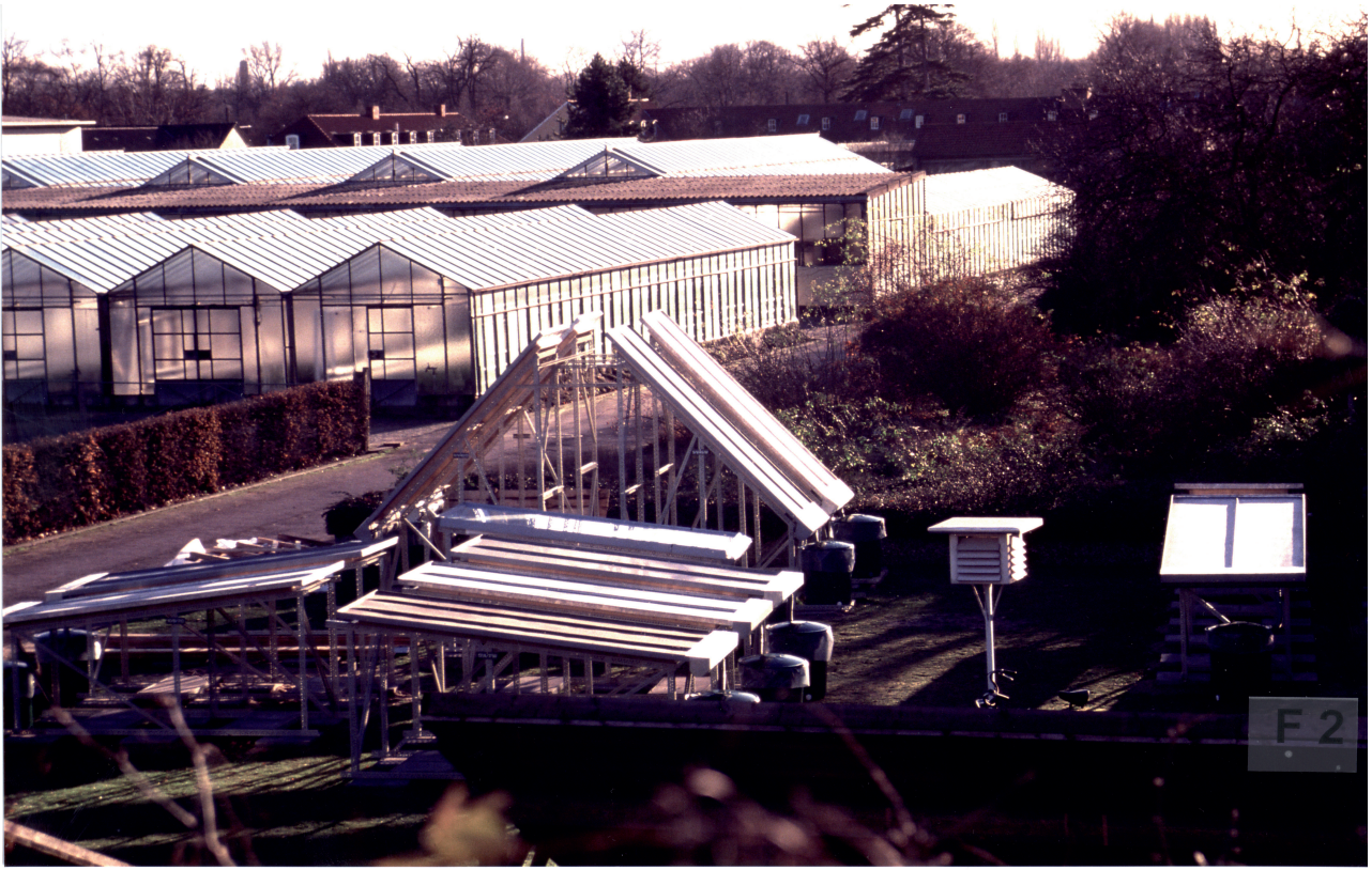
Abbildung 54: Teilansicht des Dachflächen-Freibewitterungsversuchs in Hannover-Herrenhausen, Standort A. Erster Versuchsabschnitt: 27.11.1990 bis 21.12.1993.
