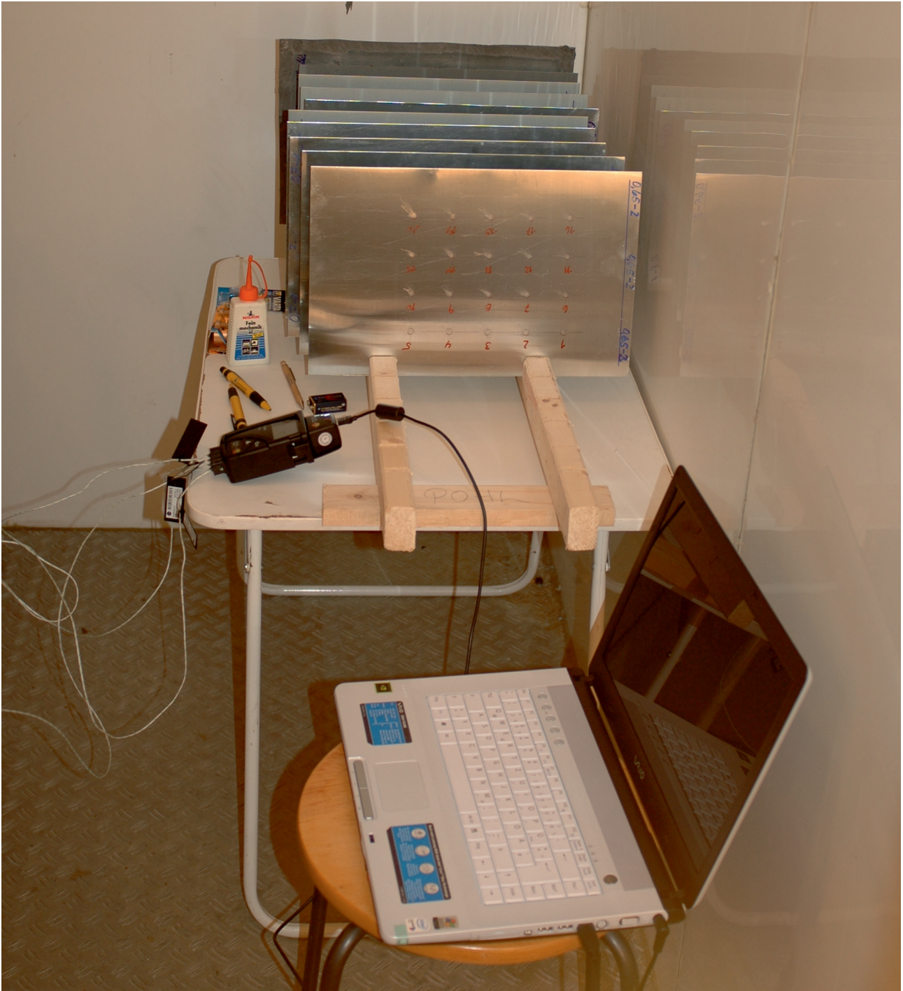
Abbildung 38: Lagerung der Titanzinktafeln in der Klimakammer, Kabelführung, Datalogger mit Interface und Rechner zur Übermittlung und Aufzeichnung der Temperaturmessungen.
