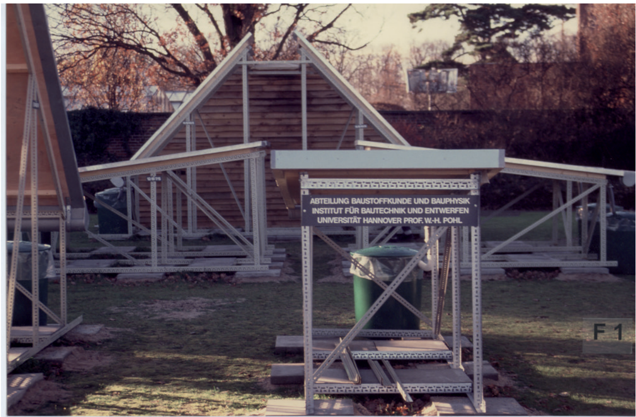
Abbildung 53: Teilansicht des Dachflächen-Freibewitterungsversuchs in Hannover-Herrenhausen, Standort A. Erster Versuchsabschnitt: 27.11.1990 bis 21.12.1993.
