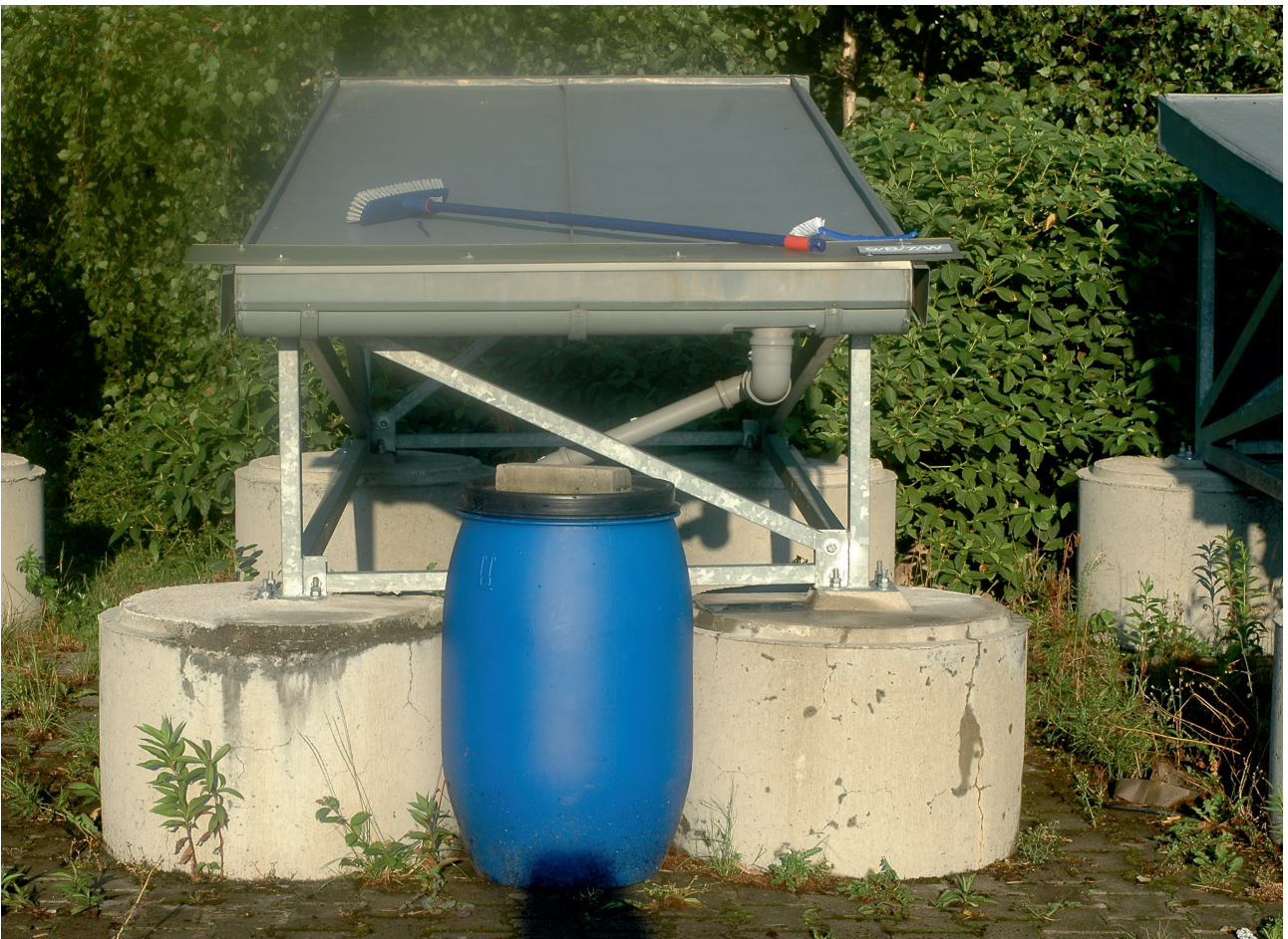
Abbildung 114: Dachflächen-Freibewitterungsversuch in Hannover-Langenhagen, Standort B. Dritter Versuchsabschnitt: 20.10.2003 bis 19.10.2013. Versuchsfläche 9-B-7-W.
