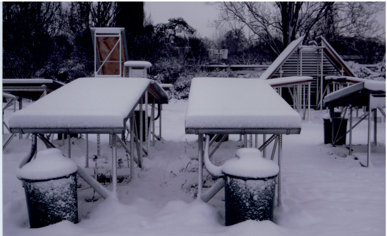
Abbildung 55: Teilansicht des Dachflächen-Freibewitterungsversuchs in Hannover-Herrenhausen, Standort A. Erster Versuchsabschnitt: 27.11.1990 bis 21.12.1993.
