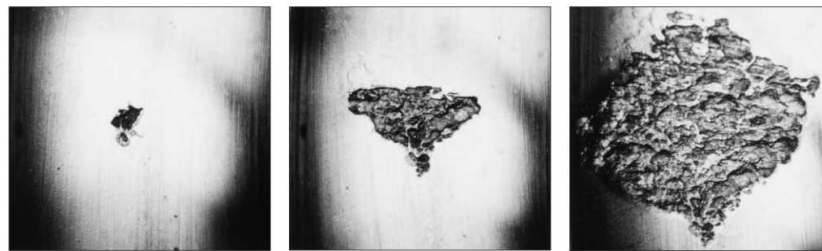
Abbildung 9: Entstehung eines Grübchenschadens (=Pitting) nach Partikelüberrollung nach [FAGoo], links : zum Zeitpunkt der Schadensermittlung, Mitte : nach 1000 Betriebsstunden, rechts : nach 1200 Betriebsstunden
