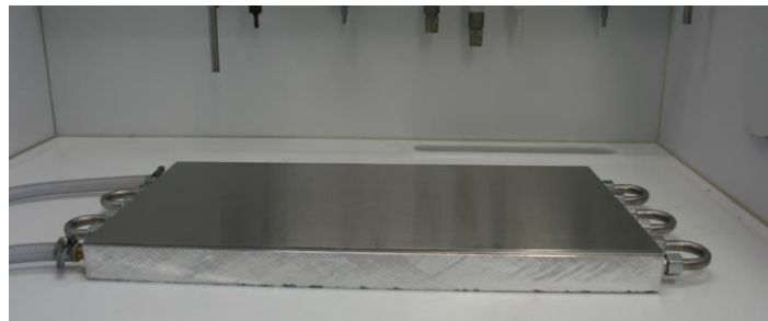
Abbildung 33: Temperierbare Platte für die Herstellung von Folien und Membranen im Labor.
