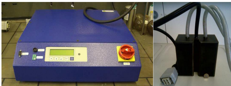
Abbildung 39: Wassergekühlter Generator EW 5 (links), Induktor (rechts).
