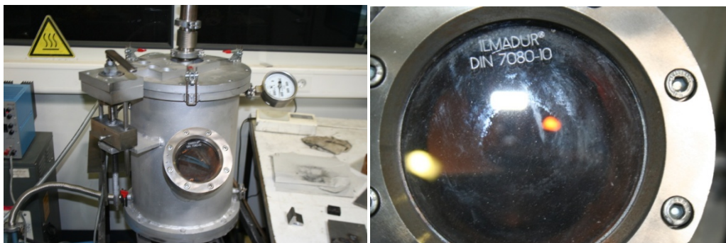
Abbildung 3.4.4: Vakuumkammer für Lichtbogenschweißen des IW (links); geschmolzene Legierung beim Glühen und Abkühlen (rechts).
