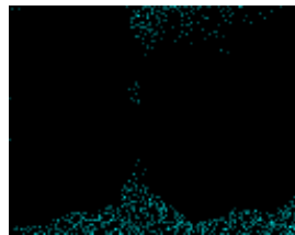
Abb. 3.1.5: \mu -RFA-Mapping für die Osmium-K-Linien bei PGE-A: Die Konzentration des Osmiums von 194.2 \mu\text{g/g} (PEARSON 2002) im Nickelsulfid ist zu niedrig, um sie mittels \mu -RFA zu detektieren. Die im Epoxidharz auftretenden Signale stammen nicht vom Osmium, sondern vom Untergrundrauschen des Harzes.
