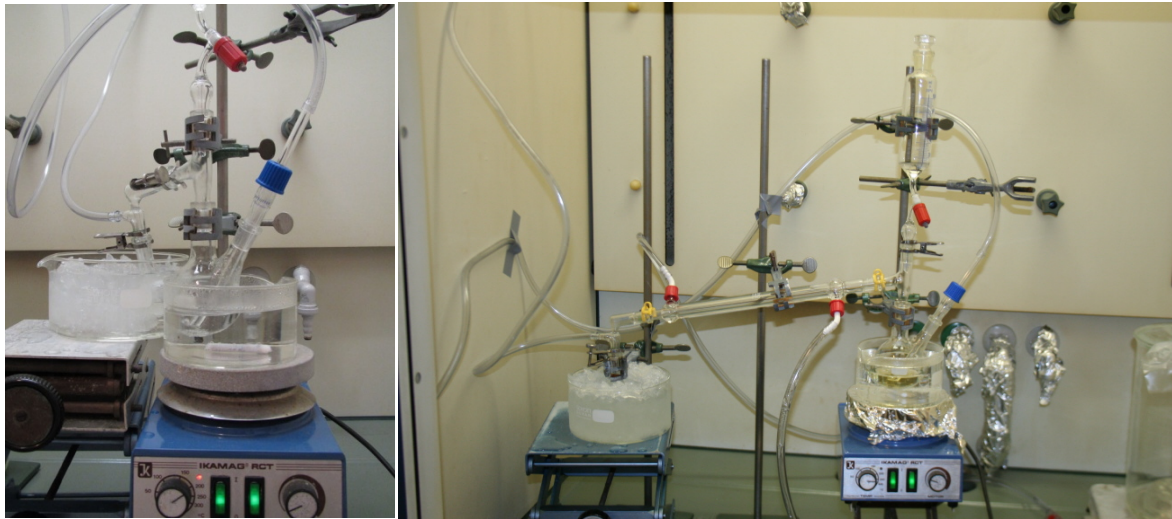
Abb. 3.2.2: rechts: Destillationsapparat 1; links: Destillationsapparat 2, sie ist um einen Kühler im Vergleich zu Apparatur 1 modifiziert.
