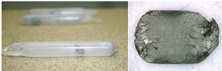
Abbildung 3.4.6: links: Fe-Os-Legierungen nach dem Tempern in Quarzglassampullen; rechts: Legierung FeOsP4 direkt nach dem Tempern (vor dem Einbetten im Harz).
