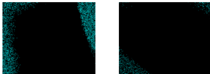
Abb. 5.5.2: Aufnahme des \mu -RFA-Mappings für die Osmium-L-Linien von MK1 (Links) und MK2 (rechts). Es ist deutlich zu erkennen, dass die Konzentration des Osmiums im Nickelsulfid zu niedrig ist, um es mit der \mu -RFA zu detektieren – im Epoxidharz ist kein Osmium, die vermeintlich positive blaue Strahlung ist Untergrundrauschen des Harzes. Die untersuchte Fläche betrug 8 mm x 6 mm. Es wurde ein 128 x 100 Messpunktraster aufgenommen. Die Messpunkte lagen bei diesem Raster ohne Messpunktüberlappung direkt nebeneinander
