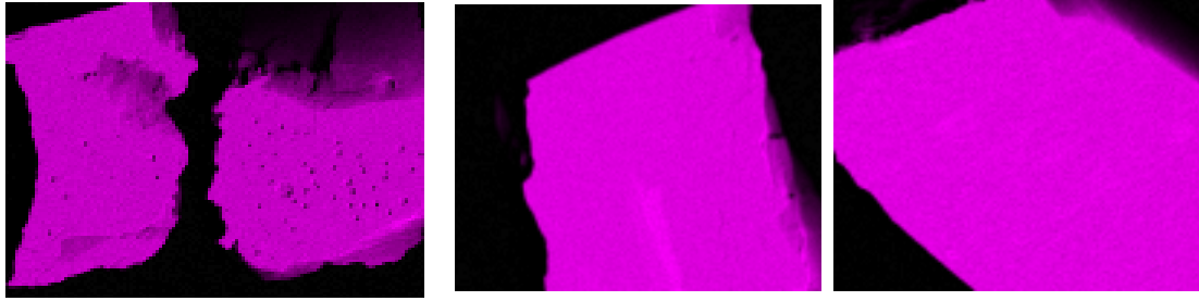
Abb. 3.1.3: \mu -RFA-Mappings für die Nickel-K-Linien; von links nach rechts: PGE-A, MK1 und MK2.
