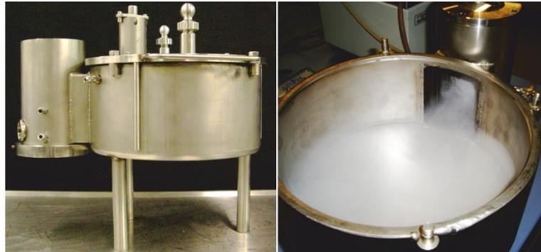
Abbildung 4.3: Seitenansicht (links) und Draufsicht mit geöffnetem Deckel der Kultivierungskammer des *NKR-Typ 0* während des Betriebs (rechts)
