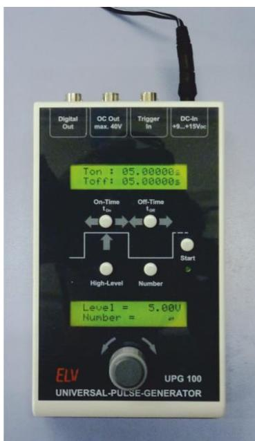
Abbildung 4.14: Universal-Impulsgenerator UPG 100 der Firma ELV
