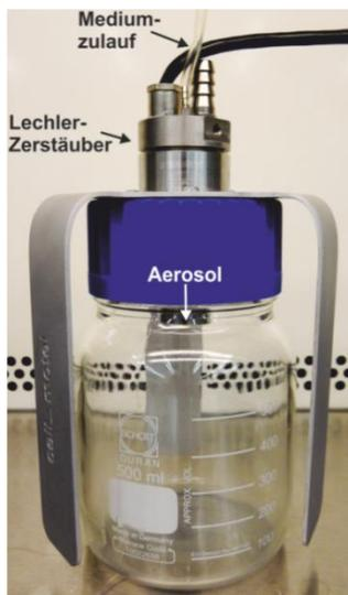
Abbildung 4.9: Messaufbau für den *LHZI-Zerstäuber*, bestehend aus einer 500ml-Schottflasche mit angepasster Halterung im Deckel
