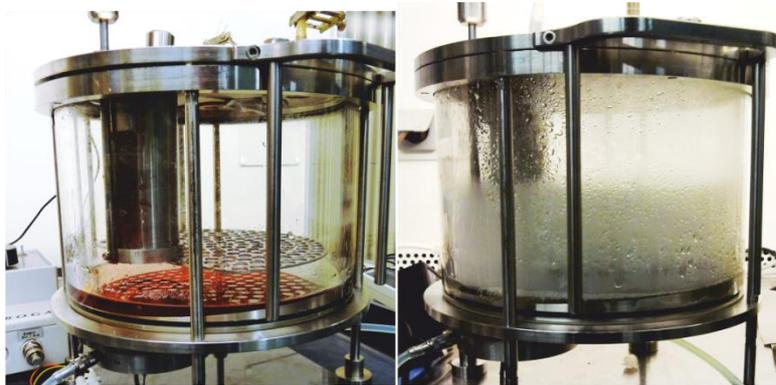
Abbildung 4.5: *NKR-Typ I* als Seitenansicht mit deaktiviertem US-Zerstäuber (links) und während des Betriebs mit 50%iger Aerosolfüllung (rechts)
