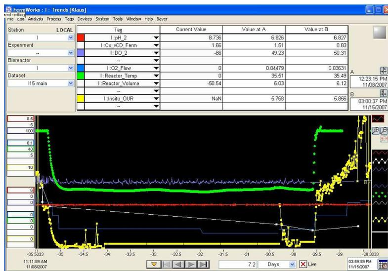
Abbildung 44: Screenshot von der Nutzeroberfläche der Prozesssteuerung während der Absenkung der Temperatur (grün) von 36,5 auf 18°C im Bioreaktor. Die OUR (gelb) fällt auf fast 0 pmol/Zelle/Tag ab. Erst mit dem Anstieg der Temperatur nach vier Tagen steigt auch die OUR wieder.
