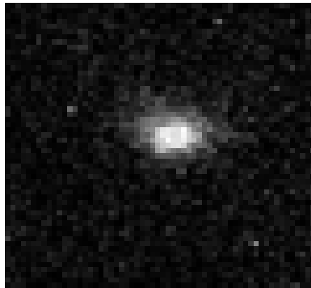
Abbildung 3.11: Fluoreszenzaufnahme von Magnesiumatomen in der T-MOT, nachdem diese im optischen Gitter gefangen waren. Mit Hilfe solcher Aufnahmen und dem in Abschnitt 2.3.3 beschriebenen Auswerteverfahren lassen sich rauscharme und hintergrundfreie Atomzahlbestimmungen durchführen.
