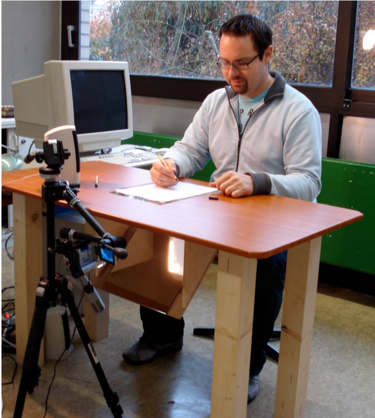
Abbildung 7: Spezial-Untersuchungstisch für videographische Aufnahmen des Schreibprozesses.
